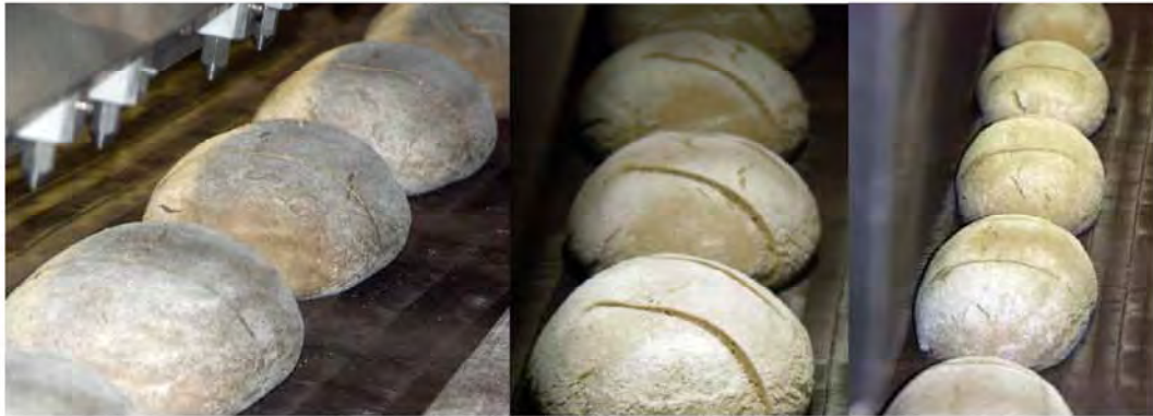
Gerader und schräger Schnitt an einem Durchlaufofen
