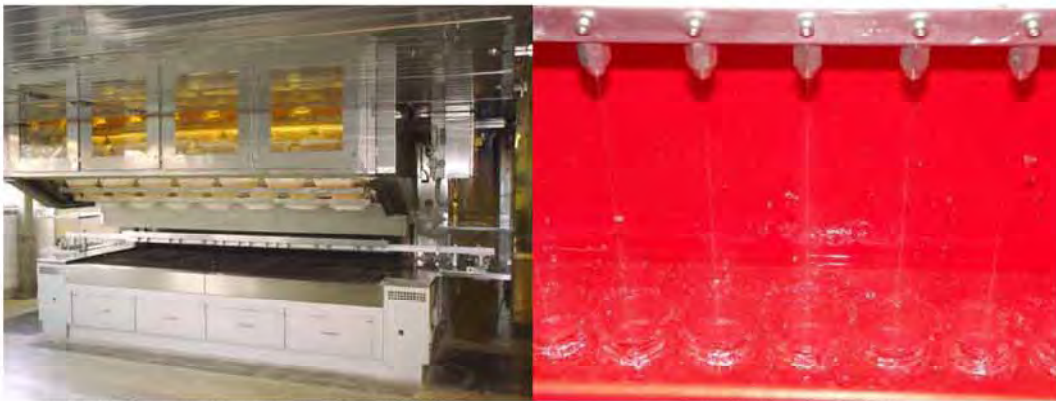
Schneidanlage an einem 3 Meter Durchlaufofen
