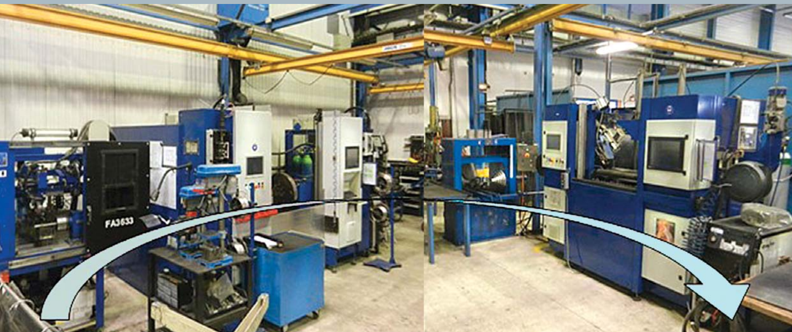
Lean-Production: U-förmige Anordnung der Maschinen und Arbeitsplätze
