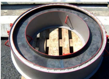
verschiedene Stahlformen zur Betonfertigteileherstellung
