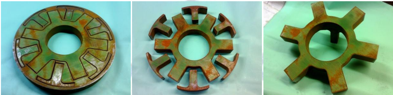
Sternring aus Stahl 60 mm Blechstärke – Wasserstrahl geschnitten
