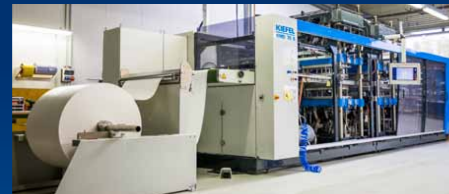
Eine unserer leistungsstarken Druckluftformmaschinen mit automatischer Entnahmeeinheit
