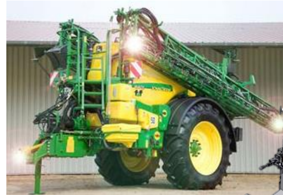
Landtechnik/Haupttrahmen für Feldspritzer 3960x1600x2200 mm
