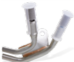
Leitungsendkappe mit Saugschaum zur Aufnahme von Restkraftstoff
