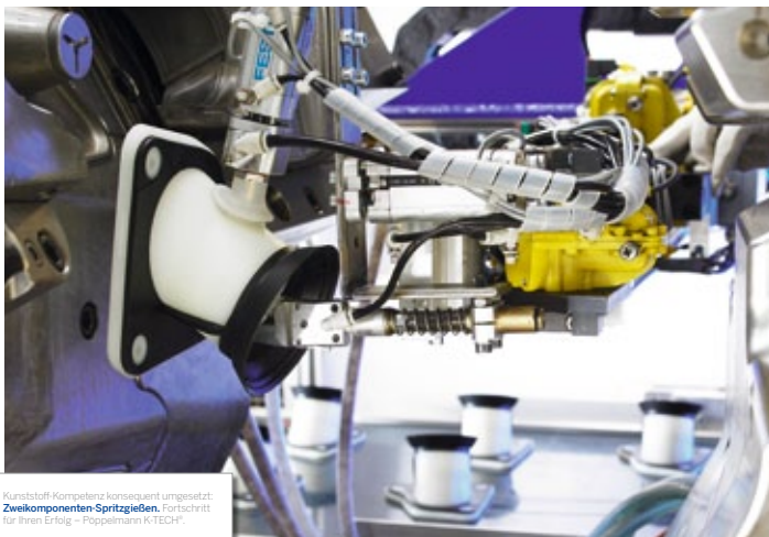
Effektiver Schutz vor Feuchtigkeit: 2K-Bodenbuchsen zur Befestigung von Kfz-Längsträgerverkleidungen
