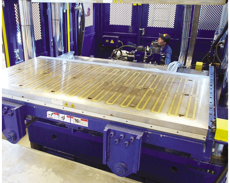
Das Magnet-Spannsystem M-TECS in einer 500 Tonnen-Pressen. Die Tischgröße misst 2000x1000mm.
