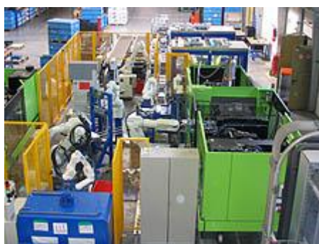
Großserien-Fertigungsline für Elektrokomponententräger eines Türschlossgehäuses der Automobilindustrie. Quarder verfügt über neun verschiedene Fertigungsvarianten. Geplante Jahresstückzahl ist 2,9 Mio., hergestellt auf vier roboterbestückten Fertigungslineen Fotos: Quarder
