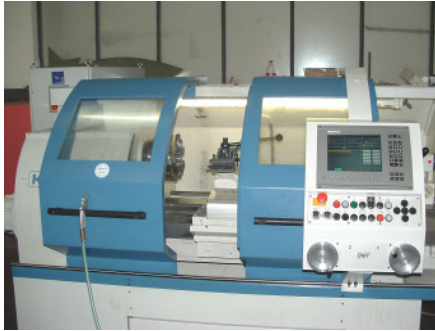
DMT Kern CD402 Zyklendrehmaschine Inbetriebnahme: 2004 Spitzenweite: 1000 mm Drehlänge: 800 mm
