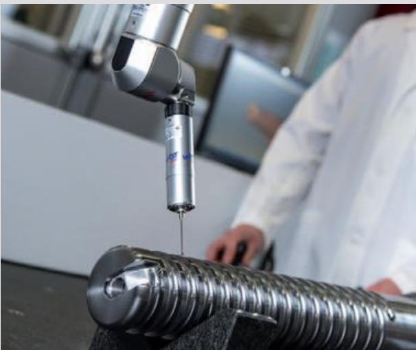
ZEISS ACCURA Portalmessgerät; Messbereich 1200x1800x1000 mm
