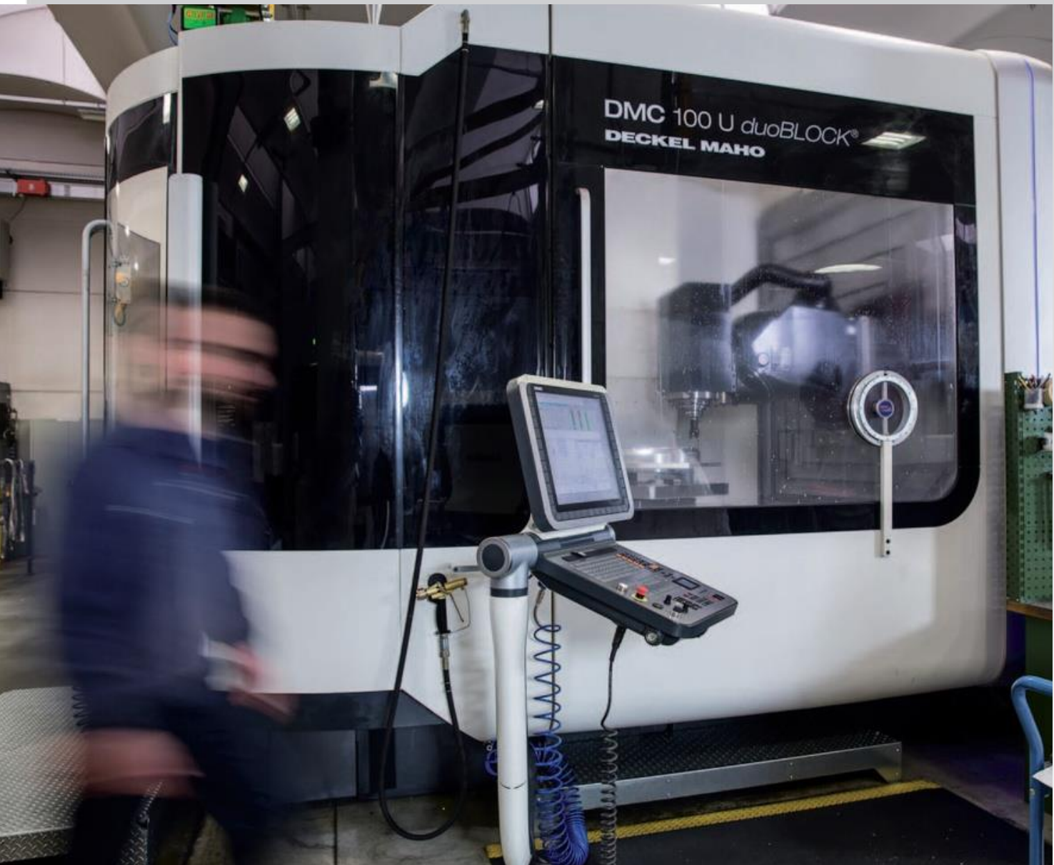
DECKEL-MAHO DMC 100U 5-Achs-Bearbeitungszentrum: Motorspindel 12.000 upm, Verfahrweg 1000x1250x1000 mm, 240-fach Werkzeugwechsler, Werkzeugvoreinstellung mit Messpunkt und Laservermessung, Palettenwechsler bis zu 2 Paletten.
