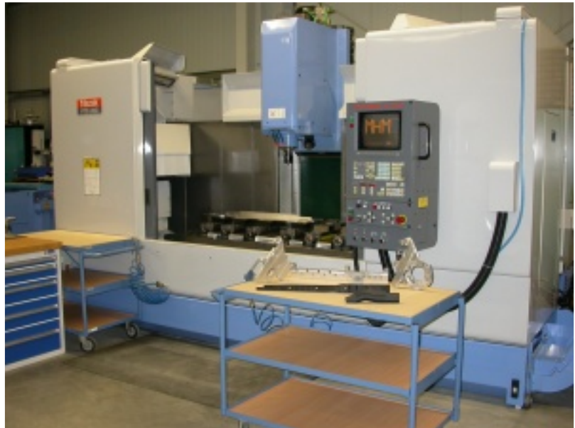
Vertikales Bearbeitungszentrum Verfahrwege X 1660, Y 510, Z 510
