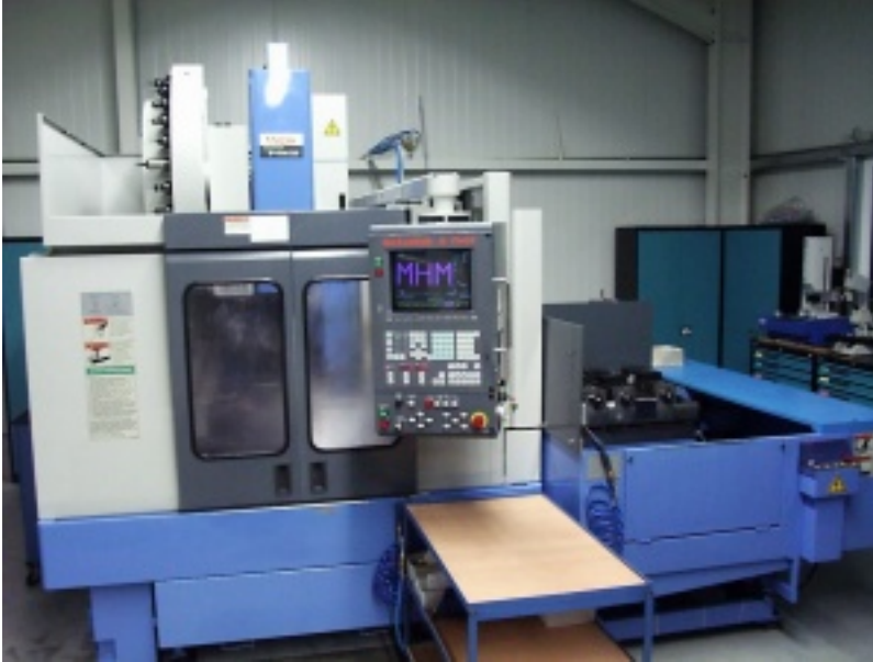
Vertikales Bearbeitungszentrum Verfahrwege X760, Y410, Z460
