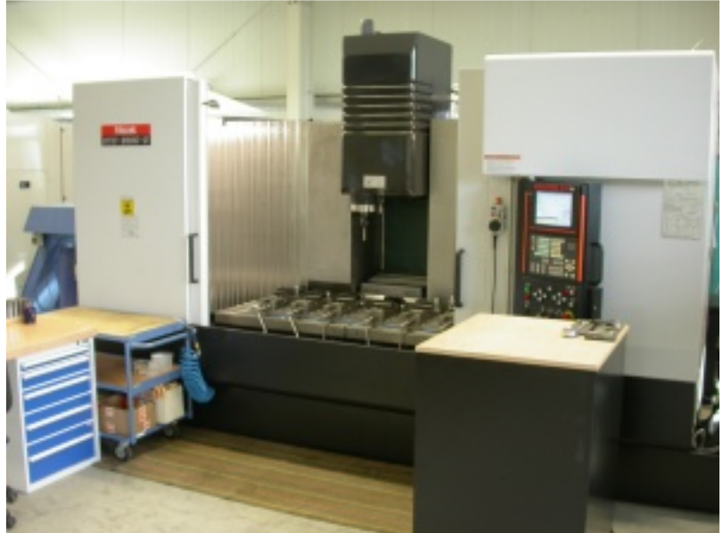
Vertikales Bearbeitungszentrum Verfahrwege X 1660, Y 510, Z 510
