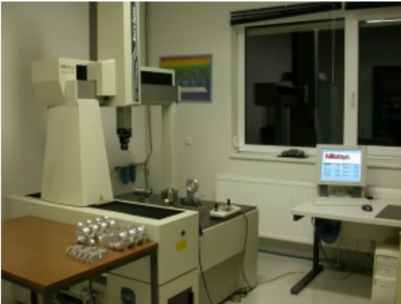
CNC - Koordinatenmessgerät Messbereich X705, Y705, Z605
