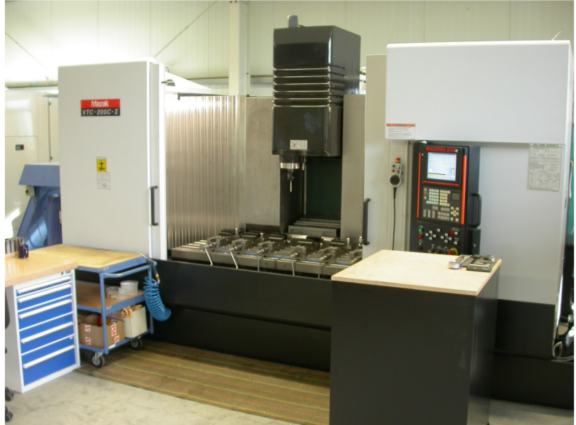
Vertikales Bearbeitungszentrum Verfahrwege X 1660, Y 510, Z 510
