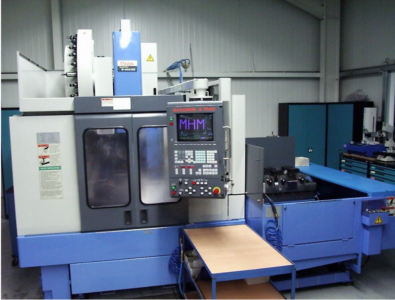
Vertikales Bearbeitungszentrum Verfahrwege X760, Y410, Z460
