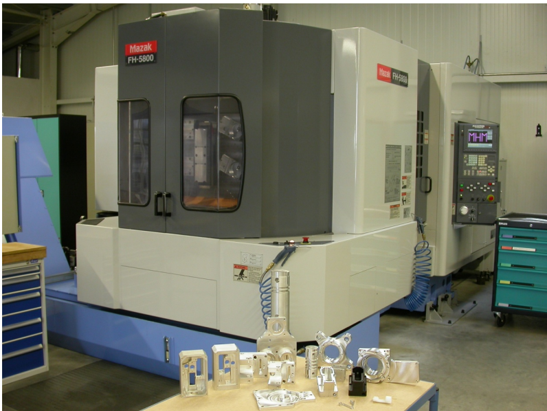
Horizontales Bearbeitungszentrum Palettengröße 500 x 500 mm Verfahrwege X 710, Y 610, Z 660, NC-Rundtisch (B-Achse)
