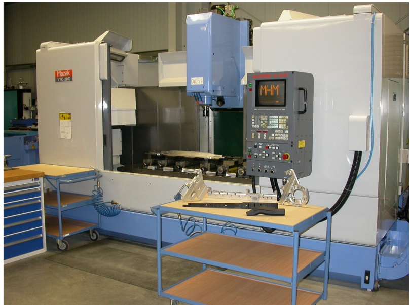
Vertikales Bearbeitungszentrum Verfahrwege X 1660, Y 510, Z 510
