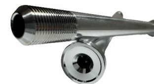
Branche Sportartikel-Industrie: Achse; Ø: 20 mm; L: 182 mm Material: AL 7075 T6
