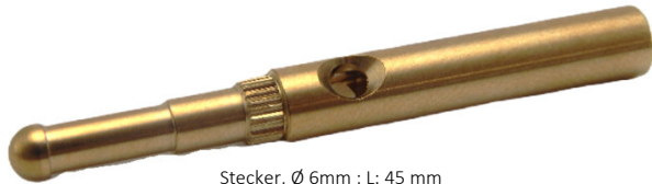
Stecker, Ø 6mm ; L: 45 mm Material: CuZn39Pb2 R500
