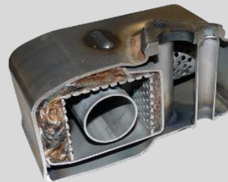
Längsschnitt des oben gezeichneten Abgasdämpfers
