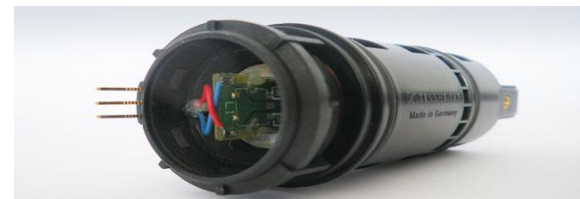
Elektronik, Bsp. Baugruppe mit Platine für Mikrofon
