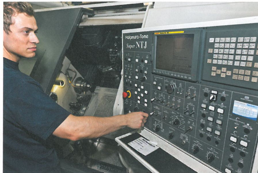
5 Flexibilität durch Können: Bei 2000 lebenden Teilen und gängigen Losgrößen von 20 bis 150 Stück gehört das Rüsten zur Tagesroutine. Nakamura Tome unterstützt das Einfahren der NC-Programme durch viele clevere Steuerungsfeatures, wie etwa die Airbagfunktion gegen Kollisionen
