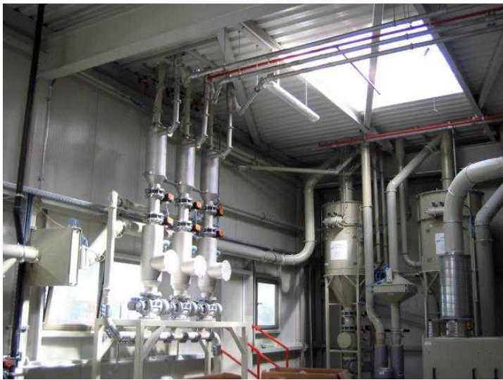
Pneumatische Förderanlage zur Absaugung und Sichtung von Waffelbruch mit Siloanlage, Inhalt 75m 3
