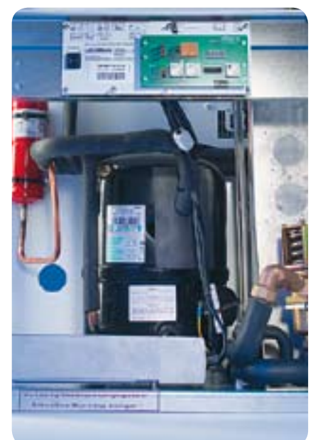
Huckepack-Aggregat (wassergekühlt) offen
