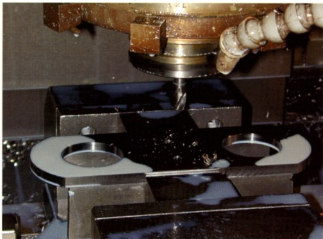
CNC-Bearbeitung von Außenlaschen und Buchsen
