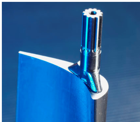
Gasturbinenschaufel aus TiAl4VGr5 Fertigungsoptimierung durch Integralbauweise, 5-achsig aus Zylinderrohling gefräst
